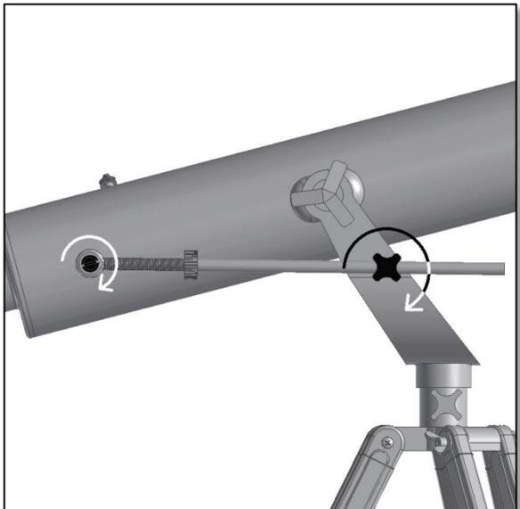
Figura 7. Asta di messa a fuoco fine in posizione.
